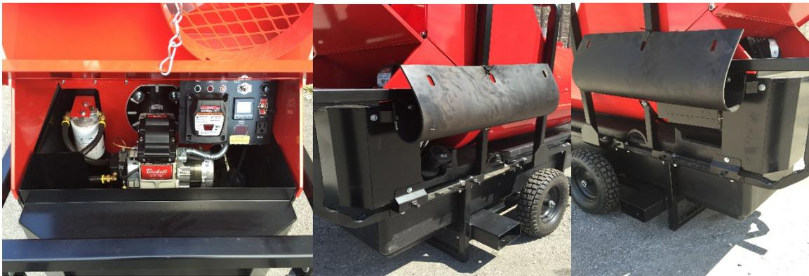
*EASY ACCESS TO FILTER, FUEL FILLER AND BURNER AREA*
