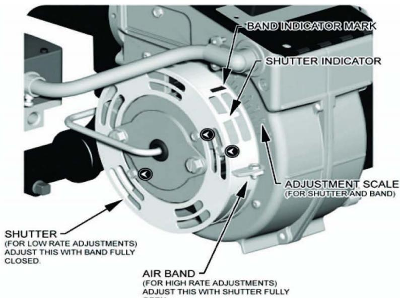
**AVERTISSEMENT : UN MANQUE D'AIR DE COMBUSTION PEUT CAUSER UN FEU, DES ODEURS DANS LES ESPACES FERMÉS ET DES REFOULEMENTS SUSCEPTIBLES DE CAUSER DES NAUSÉES OU UNE ASPHYXIE DES OCCUPANTS.**
