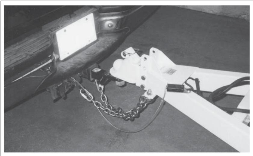
**Fig. 64 SAFETY CHAINS/BRAKE LINE**
