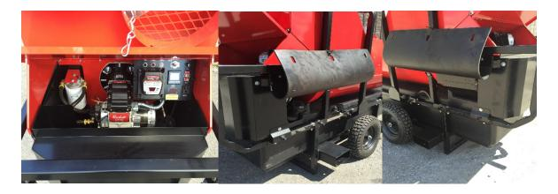
EASY ACCESS TO FILTER, FUEL FILLER AND BURNER AREA
